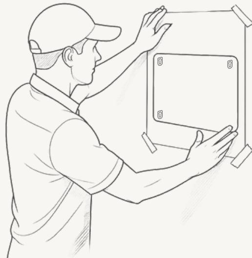
*Ce gabarit permet un positionnement exact et un alignement optimal de la borne.*
